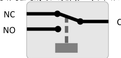
繼電器接線配置（未激磁狀態）。
