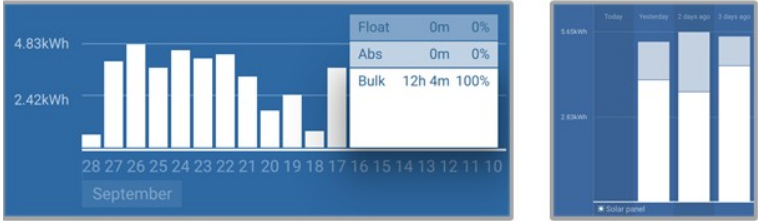
左：系統整天都處於快速充電階段的範例。右：充電階段細項分析－該系統在快速充電及注滿階段間耗用時間。
