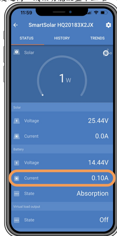
VictronConnect app 顯示接近零的充電電流
