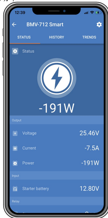
運作於DC監視器模式的電瓶監視器，其VictronConnect app狀態畫面。
